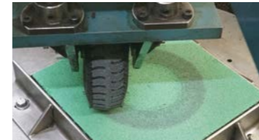
図：剥がれ抵抗性試験※1
