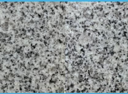
施工済部分 (透明タイプで下地を生かす) | 未施工部分
